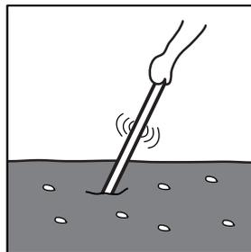
①流し込んだコンクリートにできた気泡や空洞を棒で突き、表面を滑らかにする。
