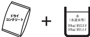
用途・工法に合わせて軟らかさを加える水で調整します。
